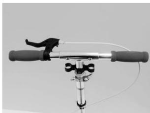
7. Coja los ejes del manillar de la pieza negra que las sujeta. Insértelos a la izquierda y derecha de la pieza T que sujeta eje manillar presionando los botones resorte. Comprobar que se ensamblan correctamente con los botones resorte.
