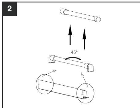
3. Installez une nouvelle lampe UV. Placez délicatement nouvelle lampe en place, tournant fermement à 45° dans le sens inverse du retrait. Lieu couvercle de la lampe UV et serrez les vis.
