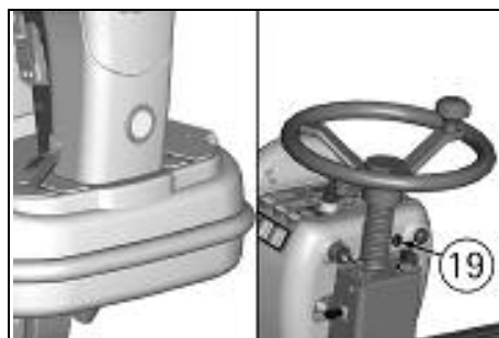
Luz de trabajo delantera y su interruptor
