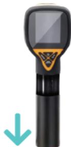
2. Saque el soporte de baterías para colocar las baterías nuevas (preste atención al ánodo y cátodo durante la instalación).
