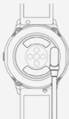
\* La montre se recharge par un système magnétique. Connectez les points aux tiges de chargement à l'arrière du boîtier selon le modèle ci-dessus. La charge débutera automatiquement. Attention à ne pas court-circuiter les deux points de chargement.
