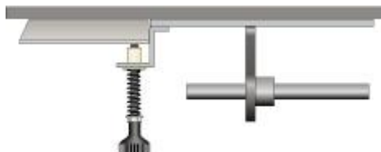
Presse d'aria minima aperta (nel caso di un tiraggio meno forte)
