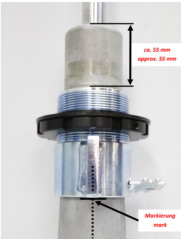
Abb. 3: Höhenverstellung aufpressen Fig. 3: Press the height adjustment on the damper
