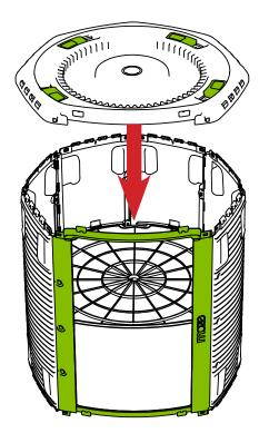
TIP: YOU MAY FIND IT EASIER IF BARREL IS ON THE GROUND AND USE SOME BODY WEIGHT TO PUSH DOWN
