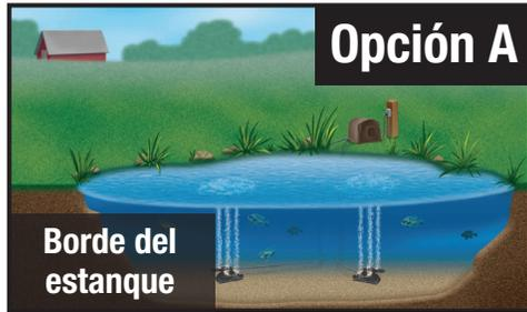
Si una fuente de alimentación está disponible cerca de la orilla del estanque, localizar el gabinete en la orilla del estanque para una instalación más rápida.
