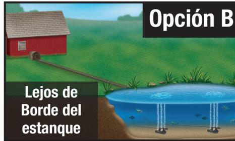
Si una fuente de energía no está disponible cerca de la orilla del estanque o prefiere instalar el gabinete en otro lugar, instale la aerolínea entiero directo (s) (se vende por separado) desde el armario hasta la orilla del estanque.
