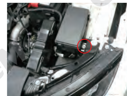
5. Remove the fuse box bolt.
