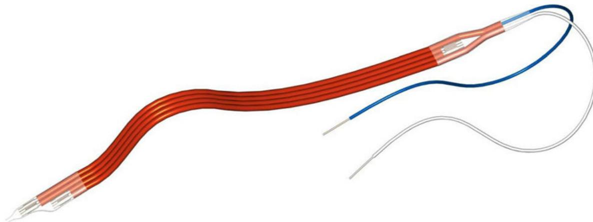
Stillstandsheizungen dienen der Vermeidung von Kondensat und verhindern Frostschäden bei Stillstand der Motoren in kalter Umgebung. Im Lieferprogramm befindet sich eine Standardausführung wahlweise mit oder ohne zusätzliche Glasseidenisolation sowie zwei weitere Ausführungen für den Einsatz in explosionsgefährdeten Bereichen.
