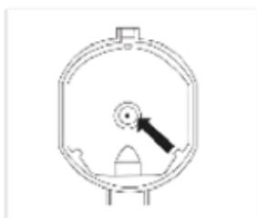
Reemplazo de la boquilla del quemador: afloje la boquilla con una llave especial (7). Ajuste la nueva boquilla de acuerdo con el tipo de gas requerido (consulte la tabla 1 para referencia). Después de convertir la placa de cocción de gas a otro tipo de gas, asegúrese de haber colocado una etiqueta que contenga esa información en el dispositivo.
