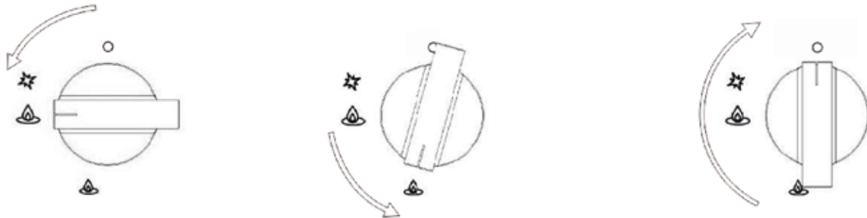
Quemador encendido, llama grande Quemador encendido, llama pequeña (modo de ahorro) Quemador apagado
