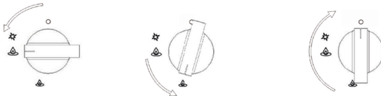
Quemador encendido, llama grande Quemador encendido, llama pequeña (modo de ahorro) Quemador apagado
