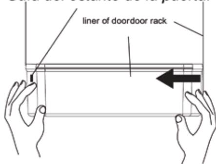
Desarmado: Sostenga ambos lados del estante de la puerta con ambas manos. Empújelo desde el lado sin la guía y empújelo hacia adentro como se ve en el diagrama. Empuje hasta que el borde del estante de la puerta se separe de la ranura del revestimiento.
