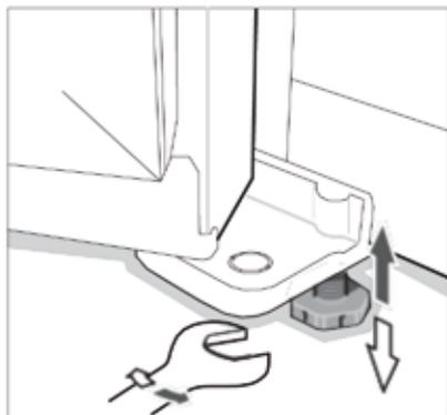
Cuando el refrigerador permanece en la caja de embalaje, las patas de plástico están apretadas. Después de sacarlo de la caja de embalaje para colocarlo, asegúrese de ajustar las dos patas delanteras de plástico hasta que la altura sea la adecuada; simplemente ajuste dos pies de plástico con una llave o directamente con la mano.
