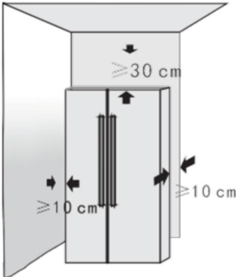
El frigorífico debe colocarse sobre suelo duro y plano; si se necesita amortiguación, se deben usar bloques de amortiguación estables, duros y no inflamables.
