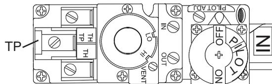
Déconnectez les fils des bornes 1 et 3 (de l'interrupteur marche/arrêt) et remplacez-les par les fils de l'interrupteur mural/thermostat millivolt.
