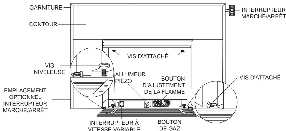
Vous pouvez installer un contour autour de l'encasté afin de couvrir la plupart des ouvertures de foyer. Fixez le contour au bord intérieur du caisson à l'aide de quatre vis d'attache. Les contours et les moulures sont disponibles en plusieurs finis pour s'agencer au décor de votre pièce. Les objets placés devant l'appareil doivent être gardés à une distance d'au moins 48" de la face vitrée de l'appareil.
