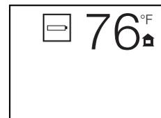
Lorsque les piles de la télécommande sont faibles, l'icône de pile apparaîtra sur l'afficheur ACL avant que les piles soient complètement déchargées. Une fois que les piles sont remplacées, cette icône disparaîtra.
