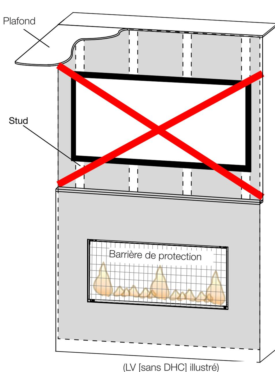
Les températures au-dessus de la cheminée pour les modèles LV SANS DHC sera chauds, rendant impropres pour le montage d'un téléviseur ou autres objets sensibles à la chaleur au-dessus de la cheminée sans risques de dommages.
