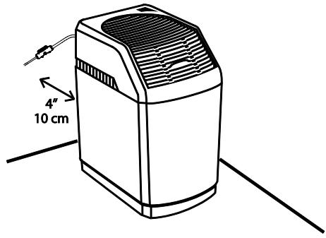
Ne placez PAS l'appareil directement devant une bouche d'air chaud ou un radiateur. NE le placez PAS sur de la moquette ou un tapis.
