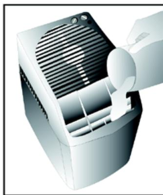
**NOTA:** En ninguna circunstancia debe usted usar productos de tratamiento de agua diseñados para humidificadores de rotocorrea o ultrasónicos.
