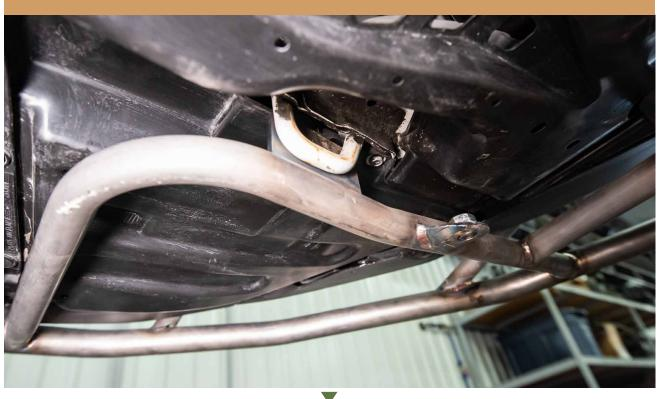
INSTALL THE BUMPER GUARD BRACKETS. -MAKE SURE TO HAVE THE CORRECT BRACKET FOR THE CORRECT SIDE
