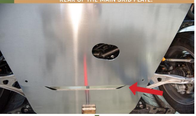
RE INSTALL THE SKID PLATE SPACERS.
