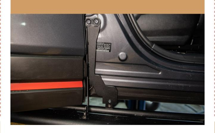
9 SECURE THE ROCKSLIDER TO THE BRACKET USING THE INCLUDED HARDWARE.
