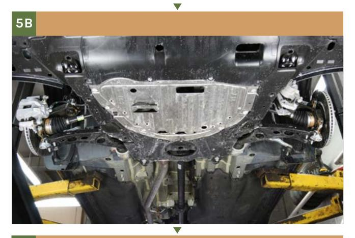
**5B** INSTALL A TIE DOWN BETWEEN THE TWO CONTROL ARMS
