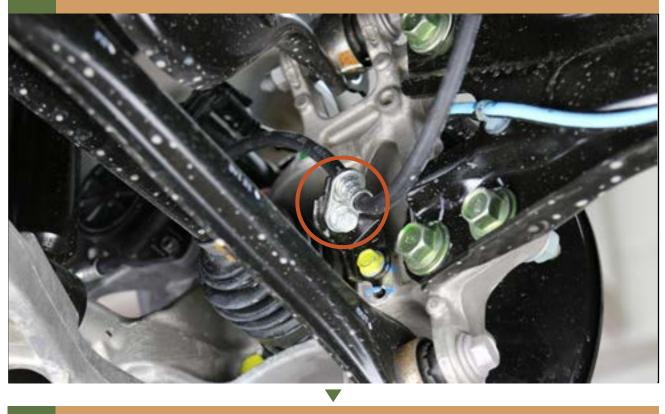
**INSTALL THE PROVIDED BRAKE LINE BRACKET(#3)**
