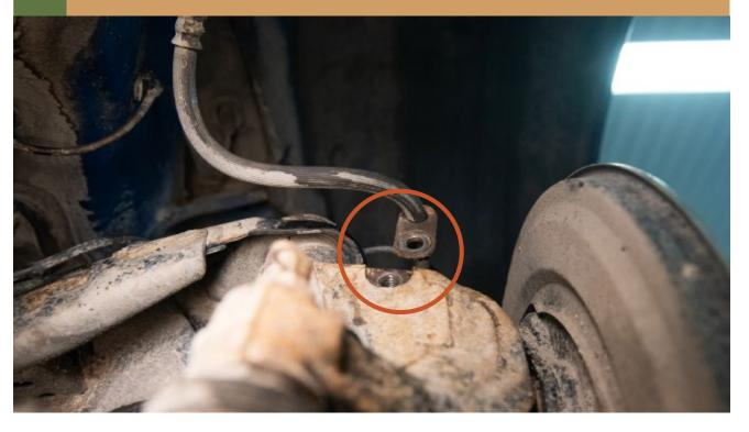
24 INSTALL BRAKE LINE BRACKET SPACER
