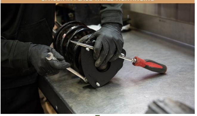
9 RE INSTALL SHOCK ASSEMBLY. MAKE SURE YOU INSTALL THE CORRECT STRUTS ON THE CORRECT SIDES OF THE VEHICLE
