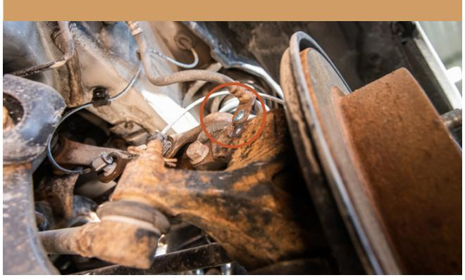
19 INSTALL BRAKE LINE SPACER
