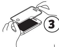
Alignez le protecteur de verre avec le dispositif en maintenant les onglets pour une application facile. Appuyez et maintenez sur le centre de la vitre avec votre doigt et enlevez ensuite l'appliqueur. (Utilisez le chiffon en microfibre pour faire sortir les bulles d'air qui se sont formées et permettre 1-2 jours pour que les petites bulles disparaissent complètement.)
