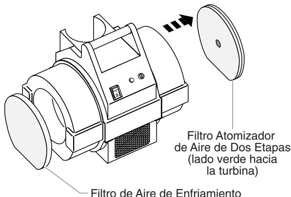
2. Limpie los filtros. Puede sacudir los filtros para sacar los contaminantes o usar aire comprimido para sopletear los contaminantes. Para material pegado difícil de separar, sumerja los filtros en agua jabonosa o espíritus minerales. Permita que los filtros se sequen completamente antes de volverlos a colocar en la turbina.
