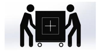
PLACE FIRE FEATURE ON SIDE TO MOVE \*SECURE PAN/BURNER PRIOR TO TILT\* (ONLY FOR SQUARE OR RECTANGLE UNITS)
