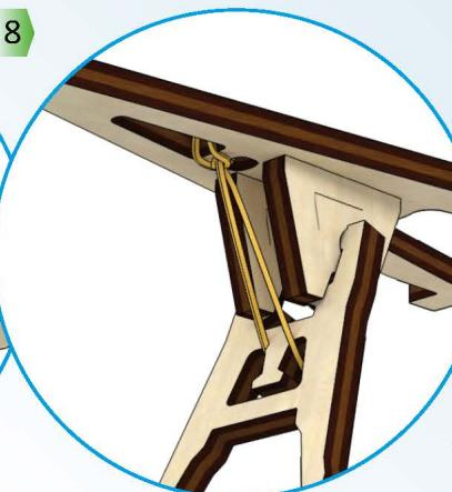
**ENG** The band should be tight. **UKR** Гумка повинна бути натягнута. **DEU** Das Gummi muss gespannt sein. **FRA** L'élastique doit être serré. **POL** Gumka powinna być naciągnięta. **SPA** El elástico debe ser ajustado. **ITA** L'elastico deve essere teso a sufficienza. **RUS** Резинка должна быть натянута. **JAP** ゴムバンドはしっかりとお結びください。ページ. **KOR** 고무밴드의 장력은 펑펑해야 합니다. **CHI** 橡皮筋必须拉紧.
