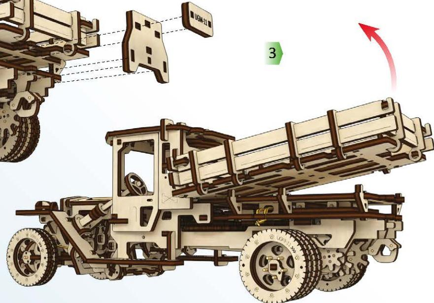
ENG Carefully remove the car body. UKR Аккуратно зніміть кузов. DEU Entfernen Sie vorsichtig den Pritschenaufbau. FRA Retirez délicatement la carrosserie du camion. POL Delikatnie zdjąć karoserię. SPA Extraiga cuidadosamente el cuerpo del coche. ITA Rimuovere il cassone con la dovuta calma. RUS Аккуратно демонтируйте кузов. JAP 注意しながら車の本体をお外しください。
