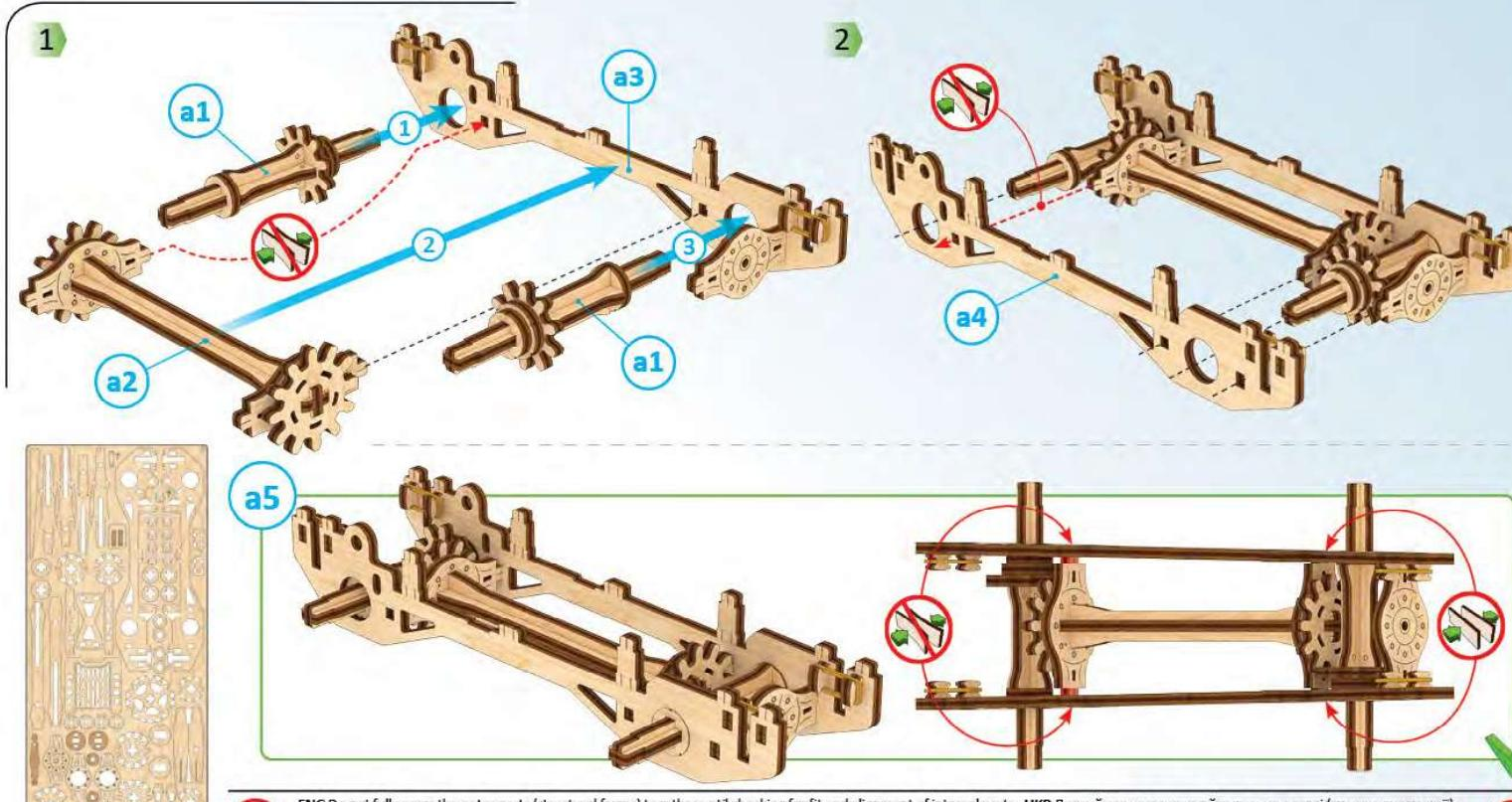
**ENG** Do not fully press the outer parts (structural frame) together until checking for fit and alignment of internal parts. **UKR** Дякай час не притискайте сильно деталі (рамки конструкції).
