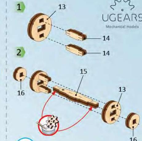
**ENG** Press the parts as far as they will go. **UKR** Притисніть деталі до упору. **FRA** Pressez les pièces à fond. **DEU** Drücken Sie die Teile bis zum Anschlag. **SPA** Pulse para detener las piezas. **ITA** Stringere bene i componenti. **JAP** 部品をできる限り押してください。 **CHI** 用力緊密結合部件 **POR** Pressione as peças o máximo possível.. **POL** Przyciśnij element, aż do oporu. **KOR** 부품을 양쪽에서 늘려서 고정해 주세요.
