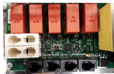
Kuva 5 RJ10 liittimien järjestys. Tuntoelin, Ovikytkin, Kauko-ohjaus, Lisä NTC
