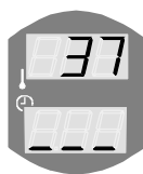
Kivitilan lämpötila paljon viileämpi kuin asetettu lämpötila
