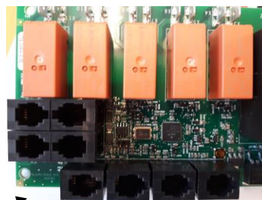
Joonis 8 . RJ 10 -konnektorite järjestus. Sensor, ukسلüliti, kaugjuhtimisseade, täiendav NTC
