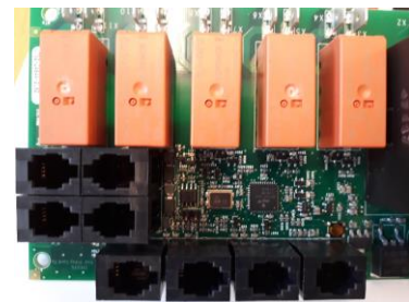
Obrázek 8 . . Pořadí konektorů RJ 10. Senzor, dveřní spínač, dálkové ovládání, další NTC
