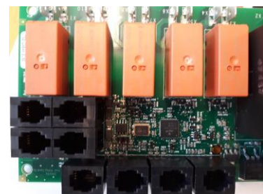
Obrázek 4. Pořadí konektorů RJ 10. Senzor, dveřní spínač, dálkové ovládání, další NTC
