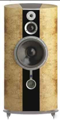
Aktiver Dreiwege-Standlautsprecher - Chassis: Hochtonchassis Ø 25mm, mit Neodym-Magnet Mitteltonchassis Ø 75mm ATC Soft-Dome Tieftonchassis Ø 375mm mit Super-Linear-Magnet Übertragungsbereich -6dB: 25Hz-22kHz
