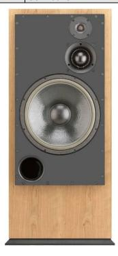
Aktiver Dreiwege-Standlautsprecher - Chassis: Hochtonchassis Ø 25mm, mit Neodym-Magnet Mitteltonchassis Ø 75mm ATC Soft-Dome Tieftonchassis Ø 375mm mit Super-Linear-Magnet Übertragungsbereich -6dB: 25Hz-22kHz
