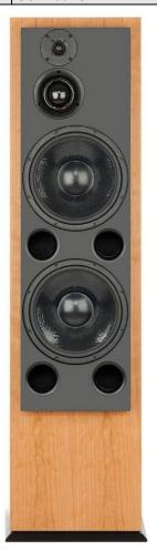
Aktiver Dreiwege-Standlautsprecher - Chassis: Hochtonchassis Ø 25mm, mit Neodym-Magnet Mitteltonchassis Ø 75mm ATC Soft-Dome Tieftonchassis 2x Ø 314mm mit Super-Linear-Magnet
