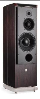
Aktiver Dreiwege-Standlautsprecher - Chassis: Hochtonchassis Ø 25mm, mit Neodym-Magnet Mitteltonchassis Ø 75mm ATC Soft-Dome Tieftonchassis Ø 234mm mit Super-Linear-Magnet Übertragungsbereich -6dB: 38Hz-25kHz
