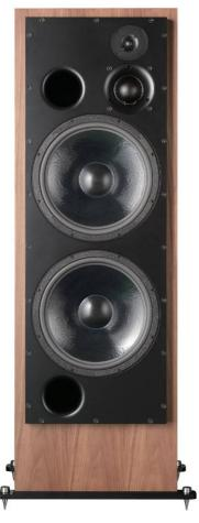
Aktiver Dreiwege-Standlautsprecher - Chassis: Hochtonchassis Ø 25mm, mit Neodym-Magnet Mitteltonchassis Ø 75mm ATC Soft-Dome Tieftonchassis 2x Ø 375mm mit Super-Linear-Magnet
