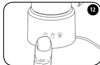
Démarrer le dispositif en appuyant sur le bouton de la préparation souhaitée. Le processus de préparation s'arrête automatiquement et l'appareil s'éteint.
