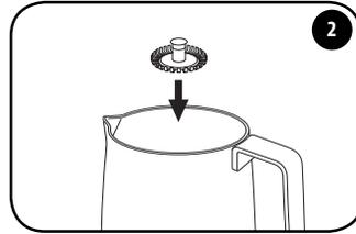
将锯齿片起泡器安装在搅拌杯身底部的中心轴上。
