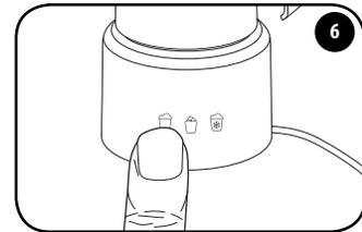
按下所需功能按键，启动设备。当饮品制作完成后设备将自动停止并关闭。
