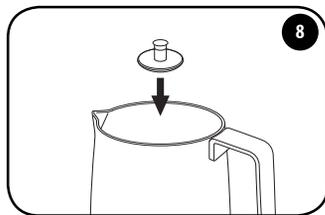
Introduire le disque dentelé à mélanger sur l'axe au fond de la carafe. Le disque lisse se trouve dans le compartiment sous la base du moteur.
