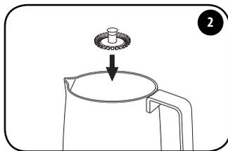
Inserire il disco dentellato nel perno sul fondo del bricco. Un disco dentellato di riserva è presente nell'alloggiamento posto sotto la base motore.
