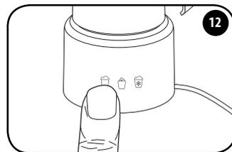
Avviare l'apparecchio premendo il pulsante relativo alla preparazione desiderata. Il processo di preparazione si arresta automaticamente e l'apparecchio si spegne.
