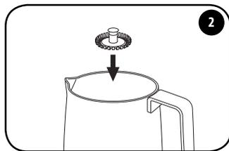
Установите зубчатый диск на штырь дна кувшина. Запасной зубчатый диск находится в отделении, расположенном под основанием двигателя.
