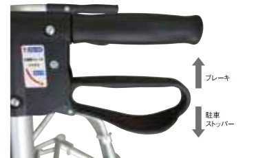
ブレーキレバーを握るとブレーキがかかります。下に下げると駐車ストッパーがかかります。 ※駐車する際は危険ですので、左右のストッパーをかけて下さい。
