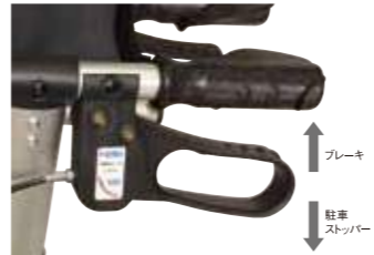
ブレーキレバーを握るとブレーキがかかります。下に下げると駐車ストッパーがかかります。 ※駐車する際は危険ですので、左右のストッパーをかけて下さい。
