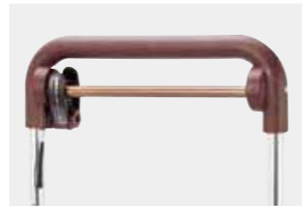
ハンドブレーキ・駐車ブレーキ レバーを押せば、駐車ブレーキが掛かるしくみ となっております。ハンドルを握れば解除します。
