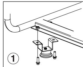
2. Install Wheels | *Instalar las ruedas / Installer les roues*
