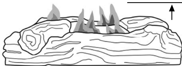
Fig. 31 - Patrón correcto/normal de la llama con llamas cortas
