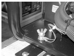
Figure 3-1. Mise à la terre de la génératrice
