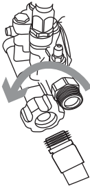
Imagen 2-9. Conexión de la manguera del suministro de agua
