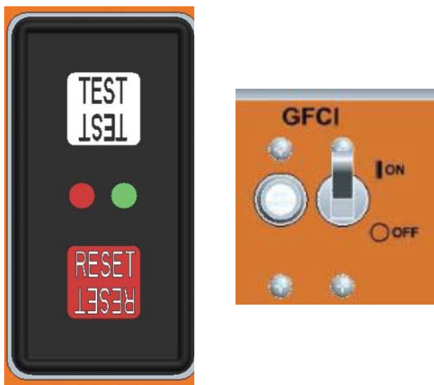
Figure 12 - Test du disjoncteur GFCI
