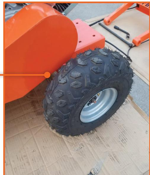
BRAKE WHEEL MOUNTS ON THIS SIDE OF THE GRINDER
