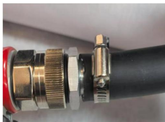
3. Insérez le tube dans le joint et fixez-le avec des pinces.
