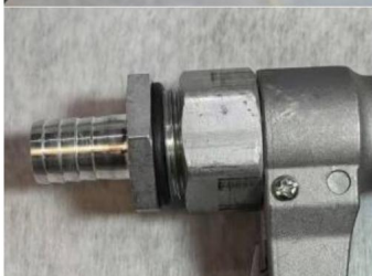
4 : Installez le connecteur sur le pistolet à huile. Insérez le tube dans le joint et fixez-le avec des pinces.
