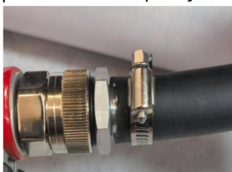
3. Włóż rurkę do złącza i zabezpiecz zaciskami.
