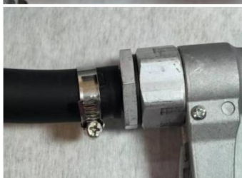
4: Zamontuj złącze przy pistolecie olejowym. Włóż rurkę do złącza i zabezpiecz z zaciskami.
