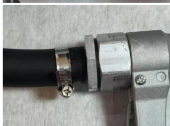
4 : Installez le connecteur sur le pistolet à huile. Insérez le tube dans le joint et fixez-le avec des pinces.
