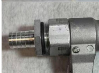
4: Zamontuj złącze przy pistolecie olejowym. Włóż rurkę do złącza i zabezpiecz z zaciskami.
