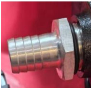
2. Installez le connecteur à la pompe sortie.
