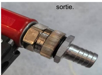
2. Installez le connecteur à la pompe sortie.
