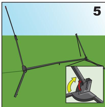
5. Toma el brazo derecho sin extenderlo completamente hacia arriba. Desliza hacia arriba el pasador de asa roja de la base en la ranura que se encuentra en medio del fondo de la base del plato.
