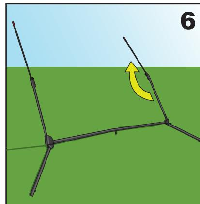
6. Totalmente extiende la barra de fibra de vidrio a la mitad del tubo derecho y asegúralo con el perno. Ambos brazos deben estar inclinados dos en la misma dirección como se muestra arriba.
