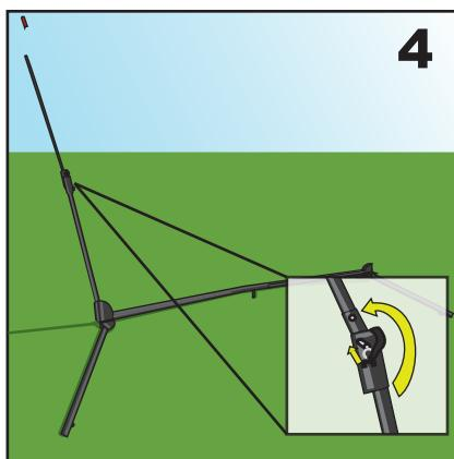
4. Sobre el brazo izquierdo, extiende totalmente la barra de fibra de vidrio a la mitad del brazo. Asegúrala con el perno.
