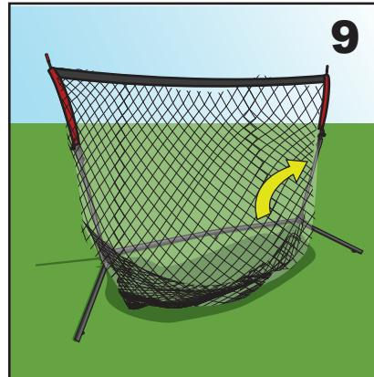
9. Jala el brazo derecho completamente en posición vertical y asegúrate que el pasador de asa roja de la base este totalmente insertado en la ranura.
