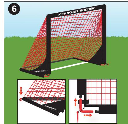
Conecte los dos postes de fibra de vidrio entre sí con las juntas de esquina rojas que tienen estacas adjuntas. Estas juntas de esquina rojas permanecerán expuestas. Sugerimos unir primero las esquinas rojas de las esquinas a los postes de la base, y luego levantar la parte delantera de la portada verticalmente para deslizar los postes frontales hacia abajo en las juntas de las esquinas. Asegúrese de que los postes de fibra de vidrio estén completamente asentados en las juntas de las esquinas.
