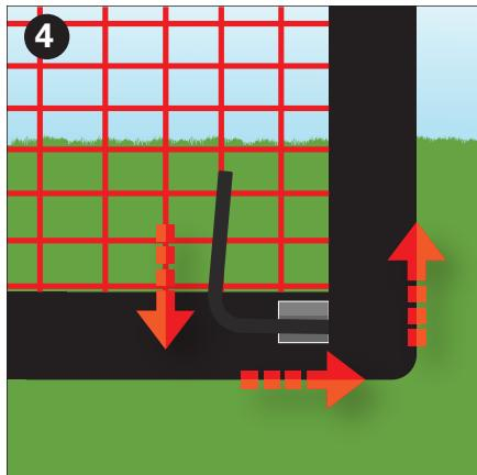
Sujete las cuatro juntas negras de las esquinas a las dos barras transversales utilizando las ventanas de montaje para que den forma estructural a las cuatro esquinas de la red. Asegúrese de que las barras transversales estén completamente asentadas en las juntas de las esquinas.
