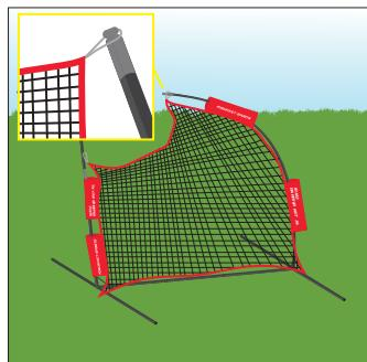
**6)** Jale hacia abajo los tubos de fibra de vidrio y sujetelos a la parte superior de las esquinas insértele a los ganchos de metal en la terminación de los postes.
