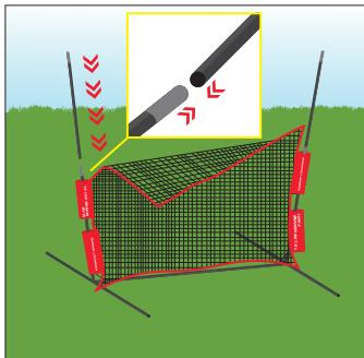
**5)** Inserte los tubos de fibra de vidrio superiores dentro de los tubos de metal que se conectan con los tubos de acoplamiento a los tubos inferiores.
