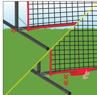
**7)** Fije los ganchos llamados bungees de la parte inferior de la malla a los postes de metal por afuera de las piernas. Despues, abroche las tiras de velcro alrededor de la barra de base. Las estacas le ayudaran en caso de las condiciones climáticas.
