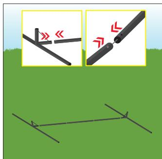
**2)** Las barras de la base están conectadas con cables. Use los botones para atorlar los juntos. Despues únalos a las piernas o bases de soporte.
