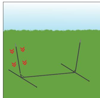
**3)** Conecte los dos tubos de fibra de vidrio inferiores (con los tubos de acoplamiento mirando hacia arriba) desde la base.
