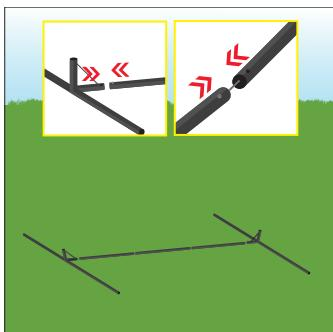
**1)** Las barras de la base están conectadas con cables. Use los botones para atorar los juntos. Después únalos a las piernas o bases de soporte.
