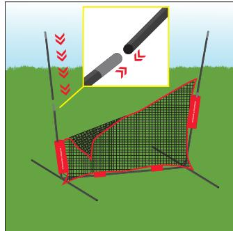
**4)** Inserte los tubos de fibra de vidrio superiores dentro de los tubos de metal que se conectan con los tubos de acoplamiento a los tubos inferiores.
