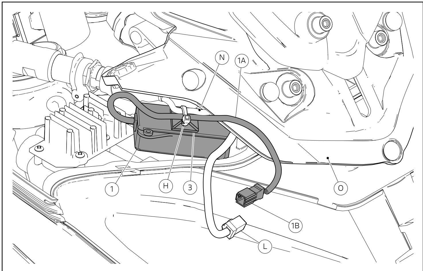
Tramite una fascetta in nylon (H), vincolare il cavo (1A) al passa fascetta adesivo (3) sulla centralina (1), avendo cura di fascettare tra di loro il cavo (1A) e il cavo ramo cablaggio presa di corrente (N), come mostrato in figura.
