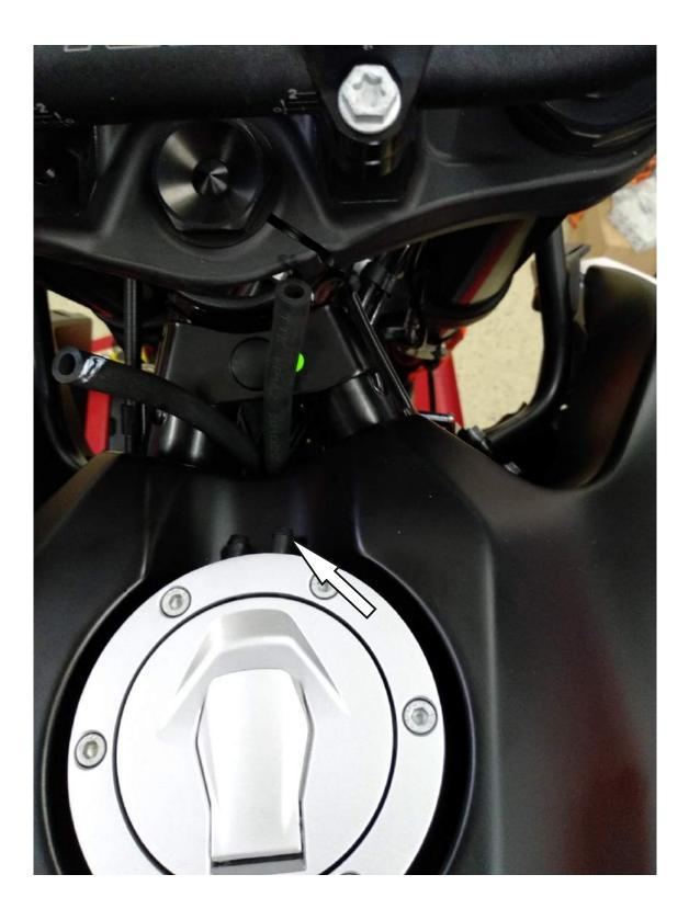
• UNLOCK FUEL LINE AND REMOVE GAS TANK
