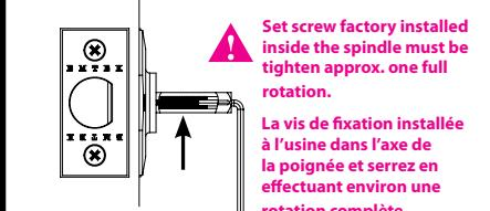
Tornillo de ajuste instalado en la fábrica dentro del eje tiene que apretarse aprox una rotación completa.
